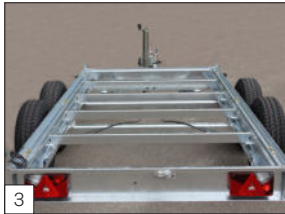
Serienausstattung: Verschweißtes oder im Vollbad verzinktes Fahrwerk für Tandemachser.
